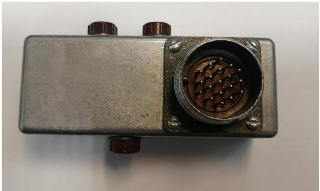
Рисунок 3.3 – Преобразователь USB-COM(ПФТ-80-8)
